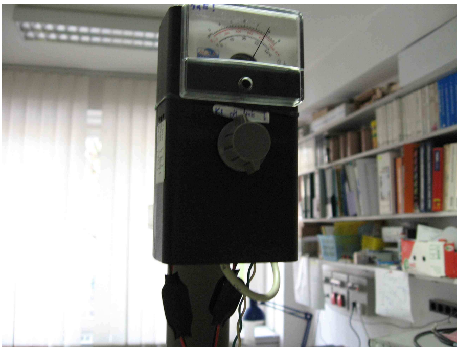
1.b ábra A talajszonda mérőegysége
