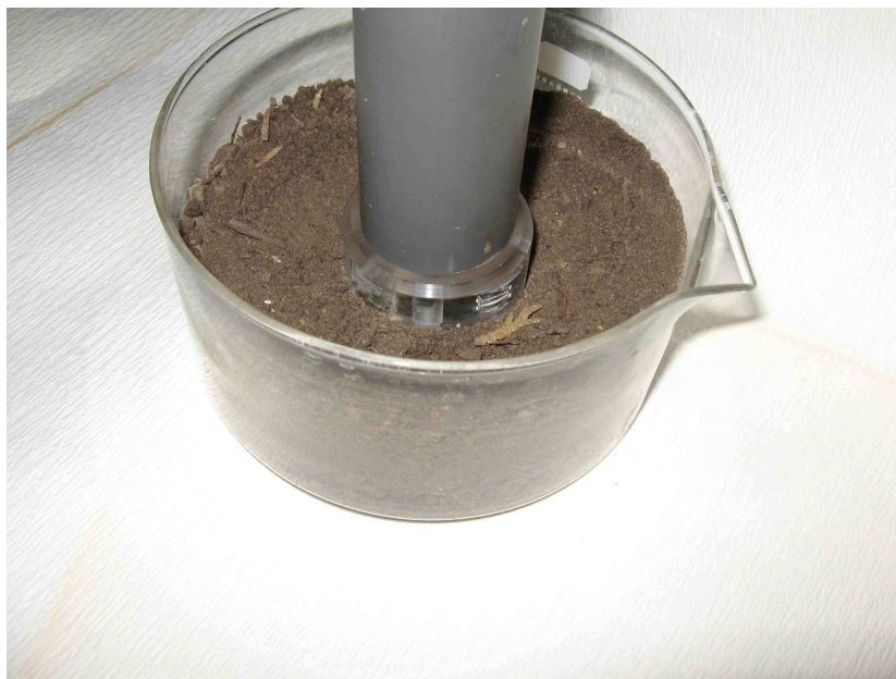
1.c ábra A talajszonda mérőfeje mérés közben
