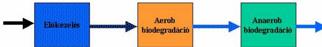
12. ábra: Kaszkádelrendezés ex situ biológiai talajvízkezeléshez
