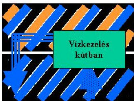
6. ábra: Szennyezett talajvíz in situ kezelése kútban
